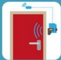
1 capteur + 1 antenne à la porte, et les passages des résidents peuvent être détectés grâce aux étiquettes déjà fournies
